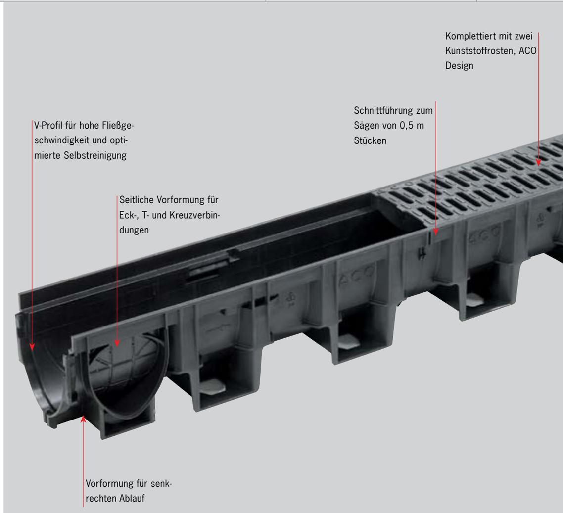
V-Profil für hohe Fließgeschwindigkeit und optimierte Selbstreinigung
