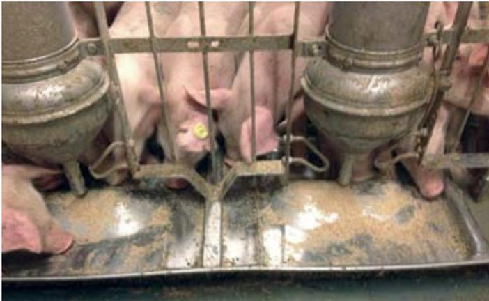
Der DOUBLE FUNKIMAT wird für eine lange Lebensdauer, überwiegend aus Edelstahl hergestellt. Der DOUBLE FUNKIMAT ist für die täglichen Anforderungen im Stall konzipiert, das Design erlaubt eine einfache Reinigung, der Futterbehälter ist Spritzwasser geschützt.
