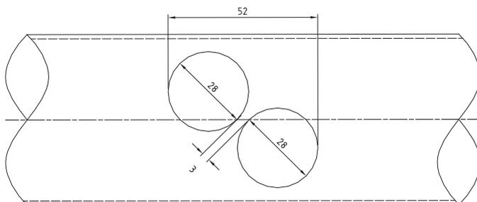
Um eine optimale Entleerung des Förderrohrs zu erreichen, werden an allen Auslässen 2 Löcher gebohrt. Diese Löcher sind gegeneinander versetzt zu bohren.
