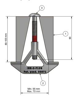
Mit einer Zugkraft von 1,8 t getestet. Angezogen mit 50 Nm.
