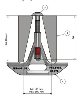
Mit einer Zugkraft von 2,3 t getestet. Angezogen mit 100 Nm.
