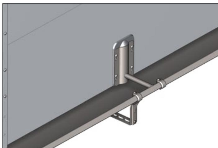
Für Flüssigfütterungswände ohne integrierter Falleitung wird ein Rohradapter zum Abdichten der Wände montiert
